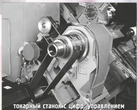
токарный станок с цифр. управлением
